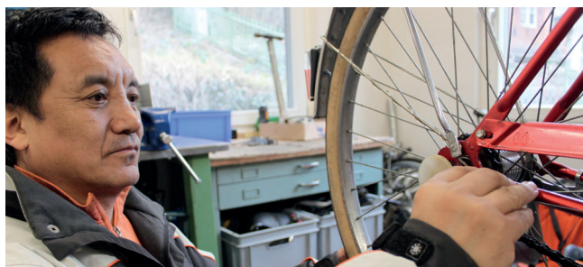
Y. R. Gyadhotsang beim Justieren einer Nabenschaltung
