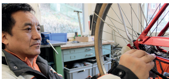
Y. R. Gyadhotsang beim Justieren einer Nabenschaltung
